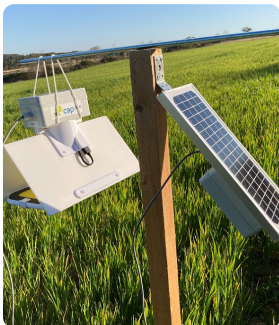
Piège CapTrap Vision Delta (à gauche) et piège CapTrap Entonnoir (à droite) utilisés pour le suivi automatisé des insectes ravageurs des cultures - Cap 2020
